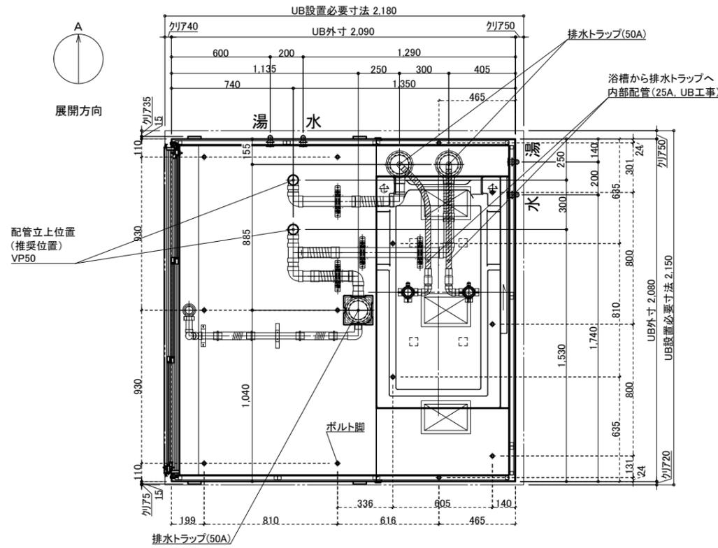
※付属の給水栓エルボ(右図参照)を管に接続し調整可能な状態で立ち上げて下さい。
