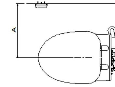
リモコンは、壁のA寸法が400~450ミリで取り付けてください。
