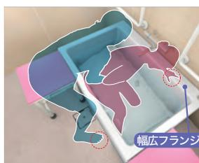
幅広フランジを壁側に配置すればフランジに手を突きやすく、器具の出っ張りを避けられます。
