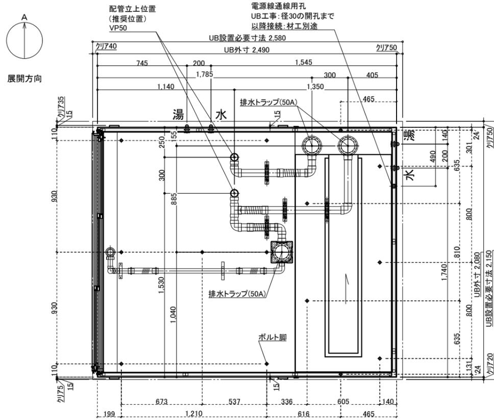
※付属の給水栓エルボ(下図参照)を管に接続し調整可能な状態で立ち上げて下さい。
