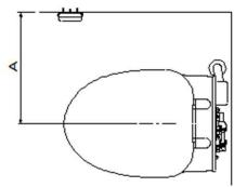
リモコンは、壁のA寸法が400~450ミリで取り付けてください。 それ以外の寸法でセンサーが反応しないときは、同梱のリモコン接続ケーブル(有線)をお使いください。
