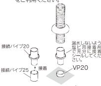
VP25の時は、接続パイプ25を 接続パイプ20に接着取付して 使用ください。
