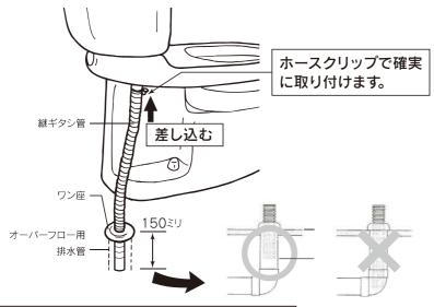
■ 既設のオーバーフロー排水管が VP20又はVP25で配管されてい る場合、附属部品の接続パイプ をご利用ください。
