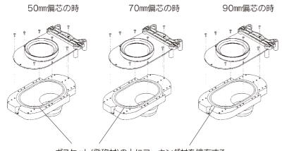
ガスケット(発砲材)の上にコーキング材を塗布する。
