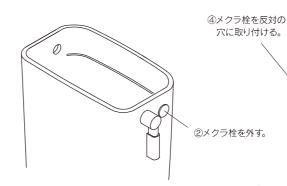
③右の穴にボールタップを差し込み、 締付ナットを締めて固定する。
