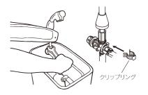
ボールタップの取付けは、真っ直ぐになるようにしてください。給水管の袋ナットを締め付けるとき、ボールタップが共回りしないようにしてください。 共回りすると、ボールタップの浮玉がロータンクの壁に当
