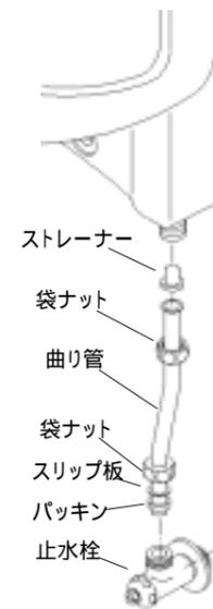
曲り管を必要な長さに合わせてカットしてください。ツバ付の方はカットしないでください。曲り管のツバ付を上(手洗器側)にし、必ずストレーナーを付けてください。
