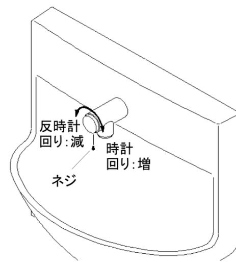
プラスドライバーでネジを外し、押しボタンを軽く回して調整してください。
