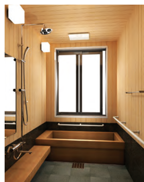
天井:羽目板張り 床:タイル張り 壁:羽目板張り(腰下はタイル張り)
