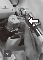
手動バレーバルブを持ち上げバルブを開く。開くと、水が出ます。
